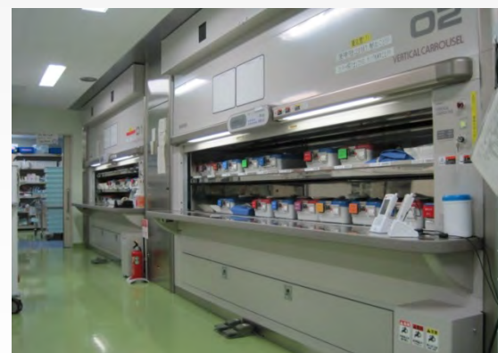
回転保管棚に滅菌コンテナを保管
