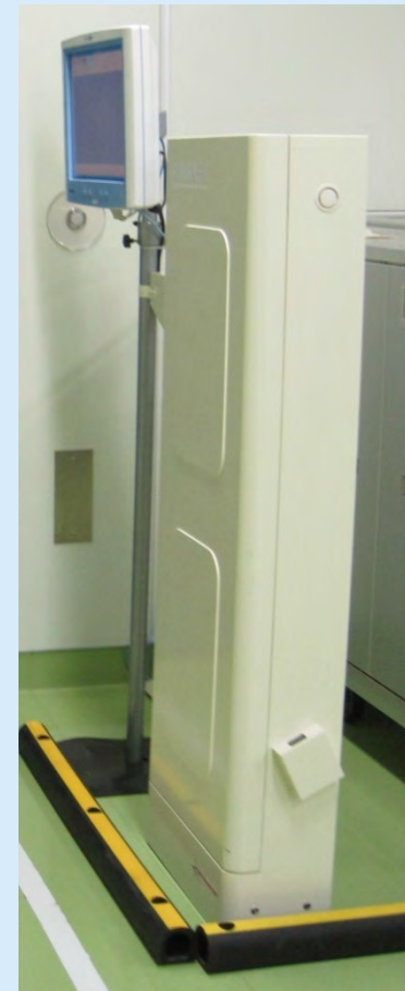
ゲートアンテナ: ラックのコンテナを一括読取り 450x200x1400mm
